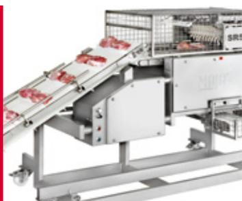
La máquina desveladora automática tipo SR 500 A es adecuada para retirar las membranas de piezas redondas de cerdo (tales como la cula-ta, la babilla y la maza) así como de ternera y vacuno con un diámetro máximo de 90mm.
